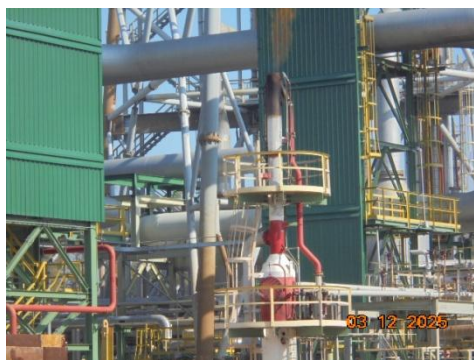
ภาพที่ 3-3 ระบบ Low Pressure Flare
